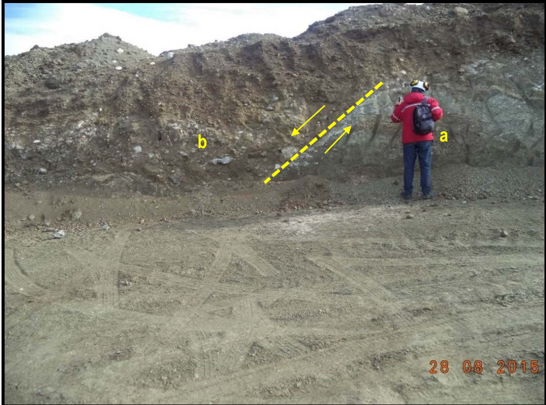
Figura 11.5: Depósito de till formado por fragmentos de roca de la Fm Santa Cruz deformados (a) y sedimentos granulares matriz soporte (b), afectados por una falla normal (c).
