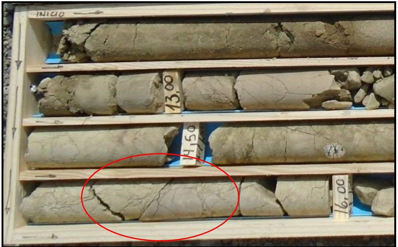
Figura 9.24: Fracturas inclinadas y brechas de deformación - Sondeo PRK 5
