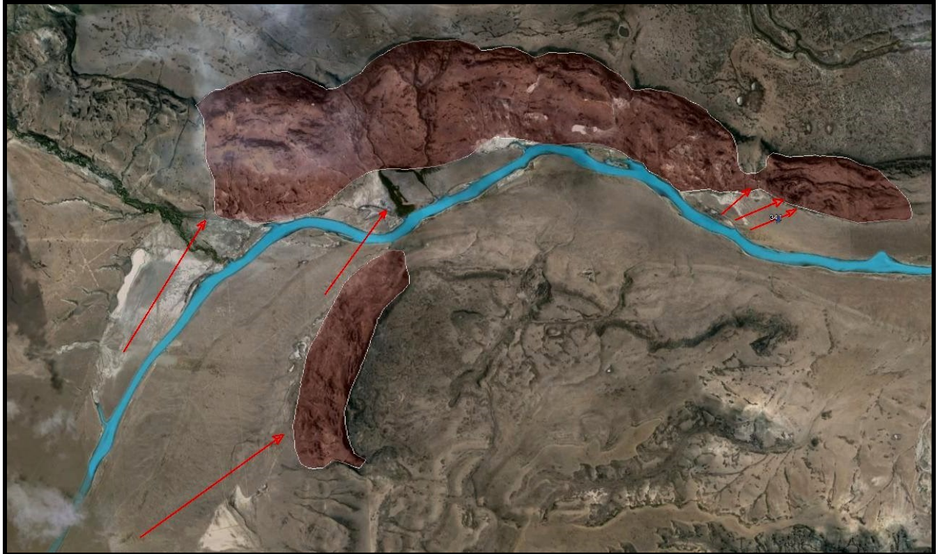
Figura 9.21: En mascara roja se señalan los procesos de remoción en masa que afectan las pendientes del valle del Río Santa Cruz en la sección fluvial que se extiende entre Cerro Fortaleza y el sitio del cierre proyectado Néstor Kirchner. Las flechas indican los vectores de dirección de la corriente obtenidos del ploteo de morfologías diagnósticas del tipo megaóndulas y formas residuales aerodinámicas
