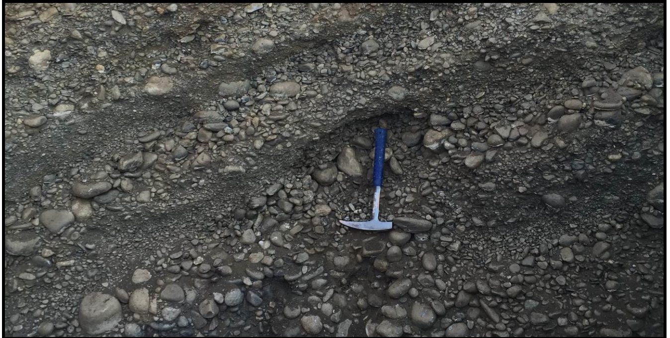
Figura 9.15: Conglomerado expuesto en la calicata 341 en la pared de dirección oeste-este
