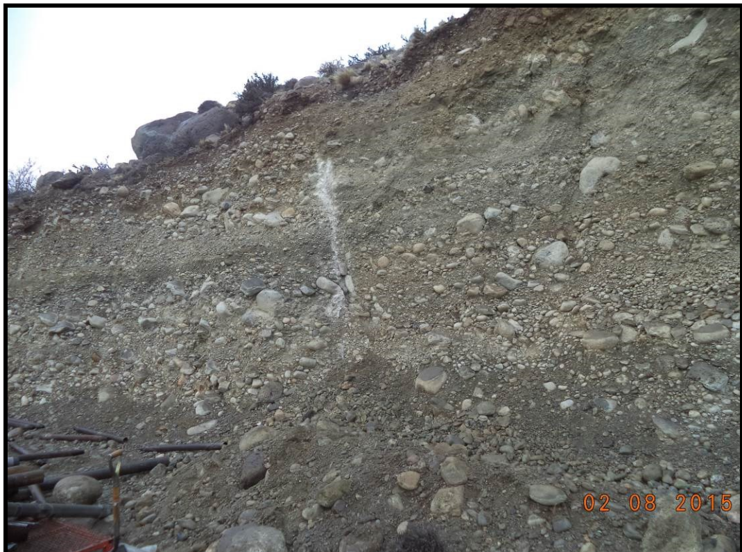
Figura 12.7: Detalle del material que forma el till intermedio - Margen Derecha.
