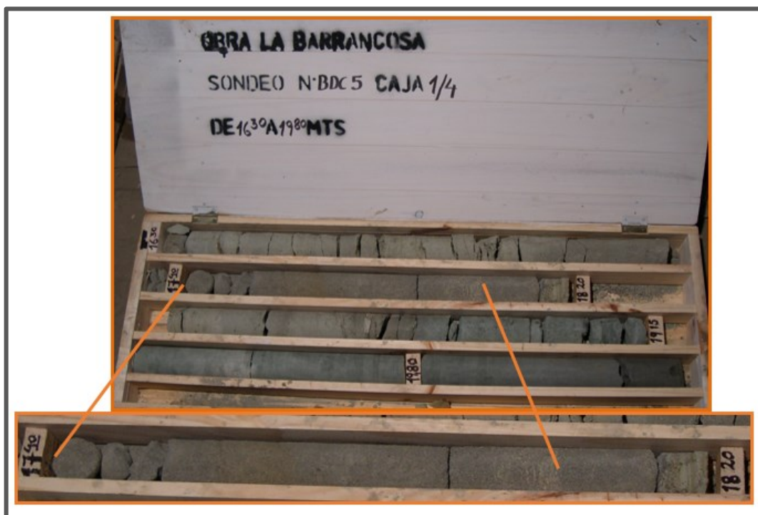
Figura 9.1: Sondeo BDC 05 con un tramo de arenisca friable
