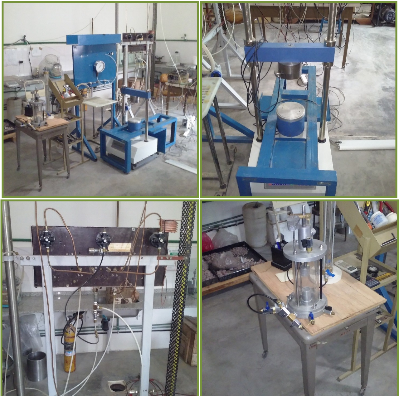
Figura 8.3: Equipo de ensayo triaxial
