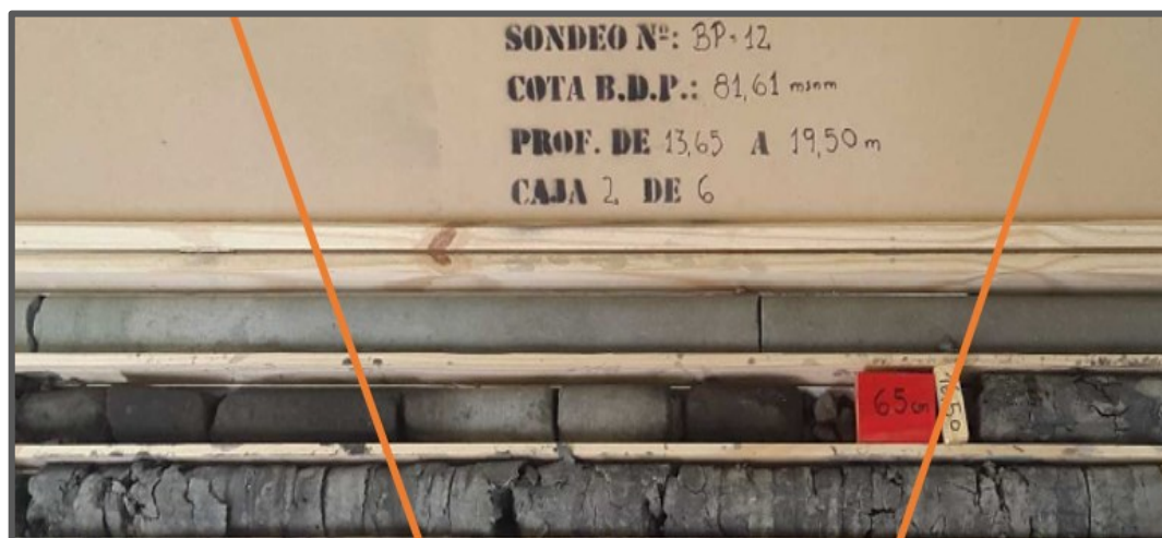
Figura 9.3: Sondeo BP 12 con tramos fracturados
