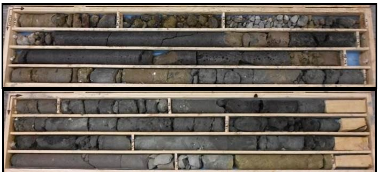
Figura 12.9: Till inferior cohesivo en el sondeo PRK 02 entre cotas 131,14 m y 110,84 m
