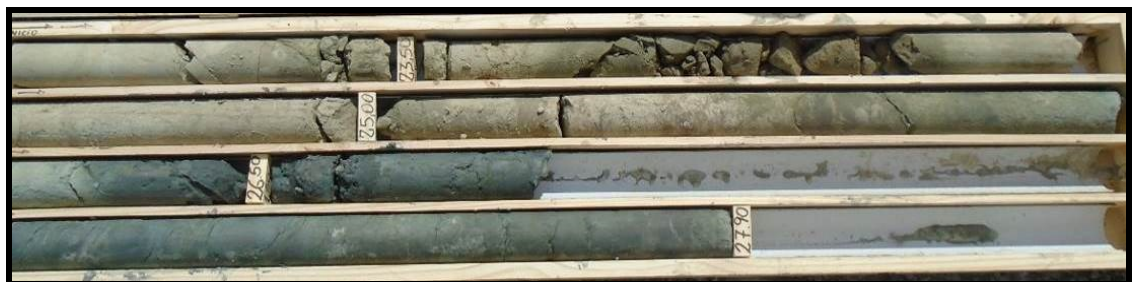
Figura 11.8: Contraste de coloración entre roca alterada (color pardo) y roca competente inalterada (gris verdoso)
