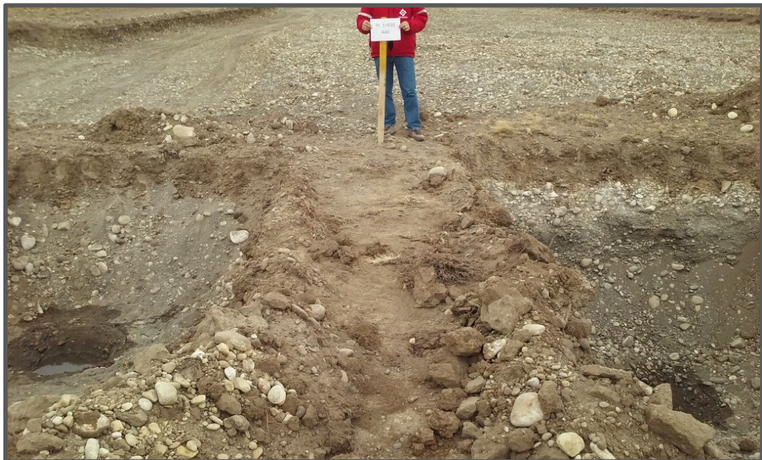
Figura 11.7: Calicata para determinación de Densidad In Situ
