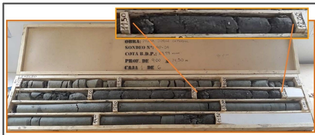
Figura 9.4: Sondeo BP 09 con roca alterada antes de los 12 m
