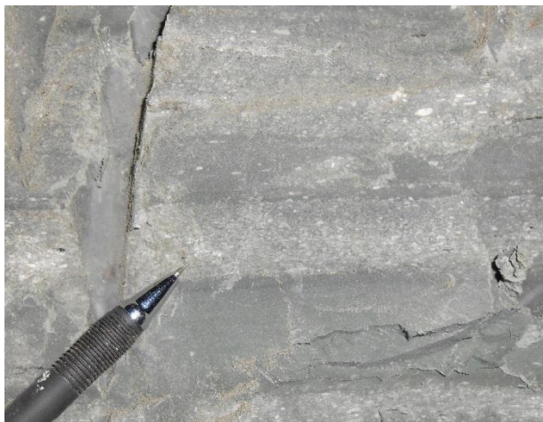
Figura 3.22: Fotografía de la pelita verde Grisácea (X) donde se observa la estratificación laminar y las intercalaciones de pelitas verde grisáceas oscuras y pelitas con depósitos piro clásticos de tipo lapilli.
