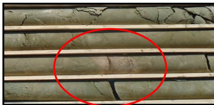
Figura 11.9: Estratos inclinados oblicuos al eje del testigo
