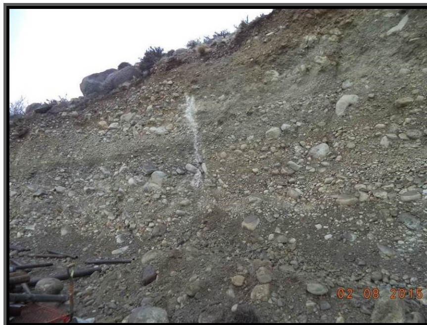
Figura 4.11: Depósito fluvio-glacial expuesto en la plataforma del sondeo SAK 6 (cota 205m) – Margen derecha
