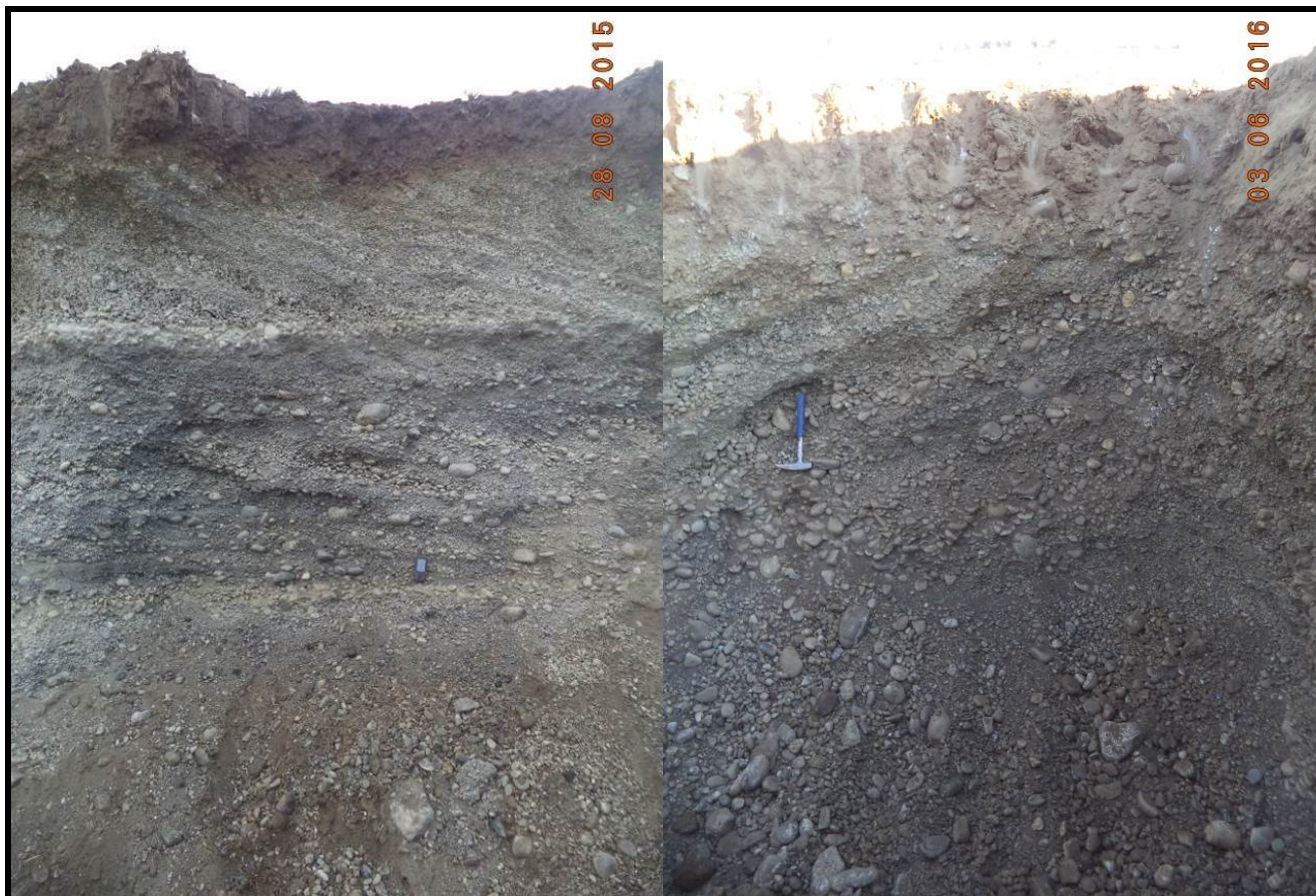
Figura 13.7: Detalle del material aluvional predominante en los depósitos del valle del río.
