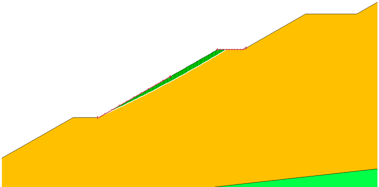
Figura 23 – Sección 3. Superficie crítica para el análisis de estabilidad local pseudoestático
