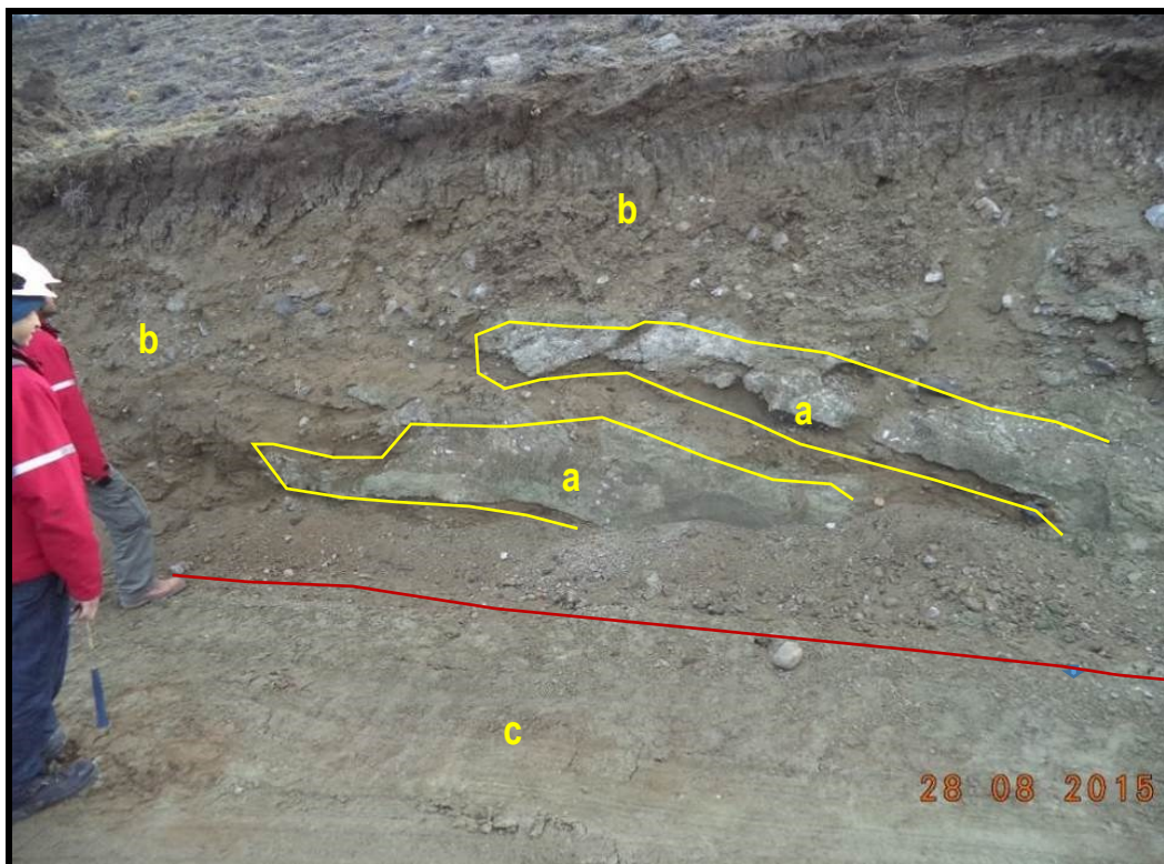
Figura 11.4: Depósito de till formado por fragmentos de roca de la Fm Santa Cruz deformados (a), sedimentos granulares (b), rocas alteradas de la Fm Sta Cruz (c).
