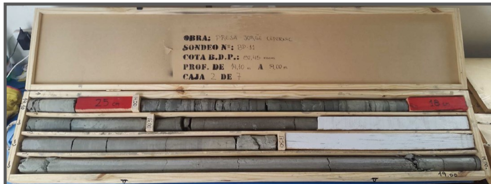
Figura 9.6: Sondeo BP 11 con tramos sin recuperación en tacos de madera roja
