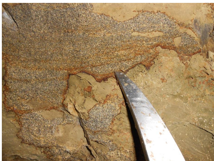
Figura 3.20: Fotografía del contacto entre las areniscas pardas (S) y las pelitas verde parda claras (T). Se observa las patinas de óxido en el contacto.
