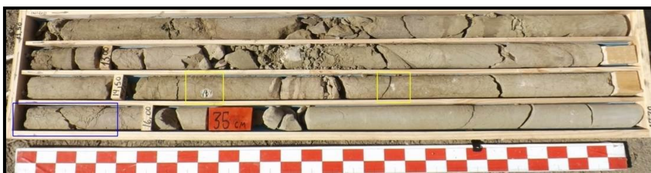
Figura 5.35: Foto del sondeo PRK 05, caja 3 de 16. Se observan concreciones de carbonato en amarillo y fracturas oblicuas en azul.
