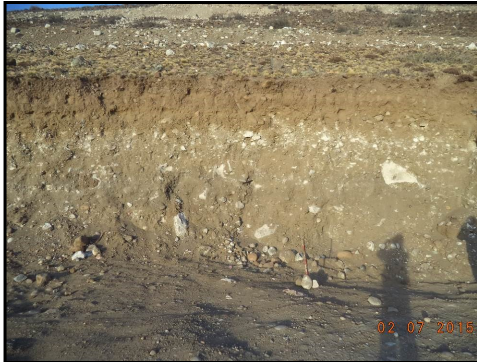
Figura 12.8: Detalle del material que forma el till inferior granular - Margen Derecha.
