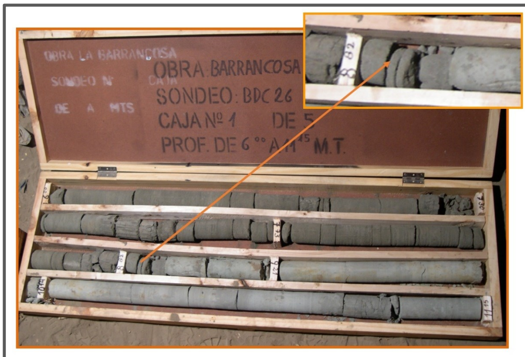
Figura 9.2: Sondeo BDC 26 con un tramo de arenisca friable
