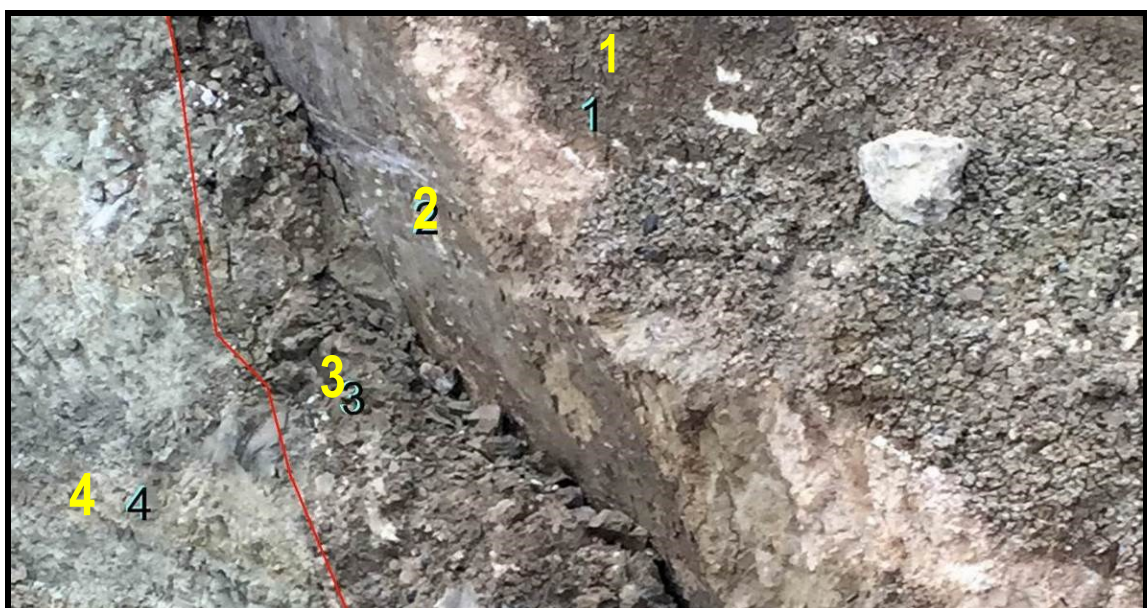
Figura 9.9: Falla vinculada con un deslizamiento rotacional donde se observa en bloque desplazado (1), la superficie de la falla curva (2), un dique clástico (3) y el respaldo del bloque movilizado (4).
